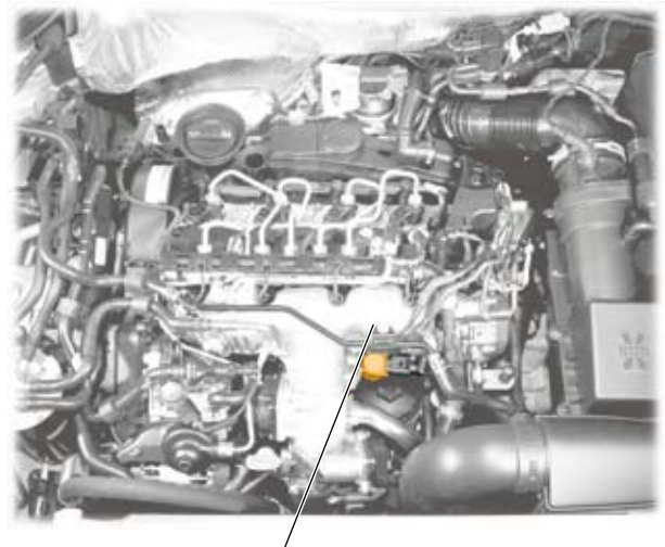
Umschaltventil für Kühler der Abgasrückführung N345
